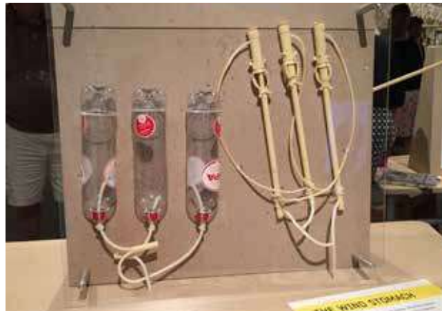
Система воздушных резервуаров и поршневые механизмы привода «существа»
