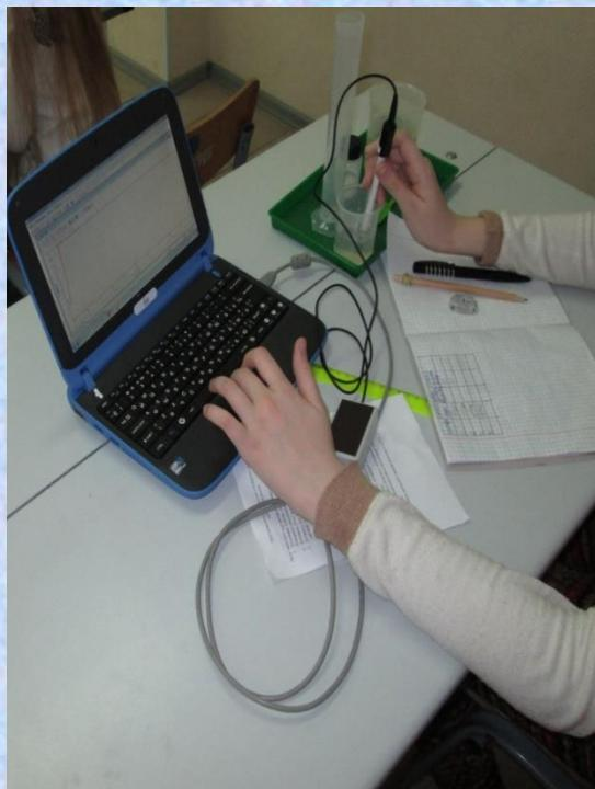
Опыт: измерение электропроводности исследуемых образцов минеральных вод.
