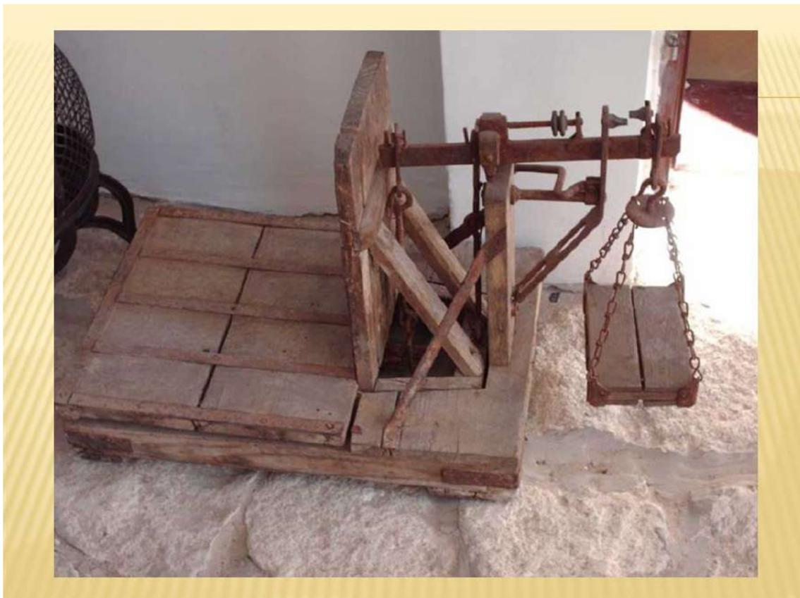
Слайд 5. Древние арабы придумали весы с передвижной гирей. На металлической планке, рычаге, устанавливалась гиря, которая свободно двигалась вдоль планки. К одному концу планки подвешивался груз, вес которого надо было определять, а гиря передвигалась по планке с делениями и показывала вес. Такие весы называют безменом.
