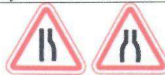
Знак "Сужение дороги":
