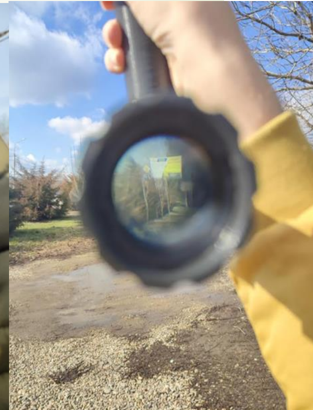
Старикова Марина изготовила перископ с увеличением, все детали создала на 3D принтере (кроме линз, конечно)
