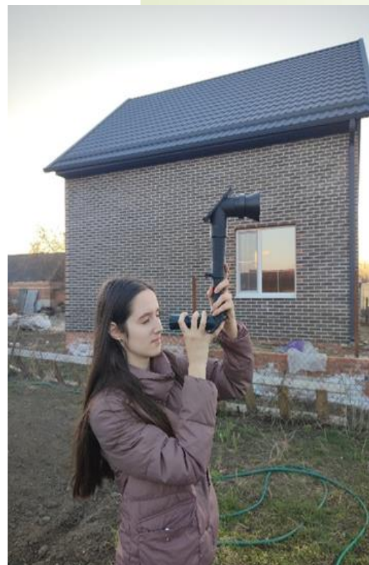
Старикова Марина изготовила перископ с увеличением, все детали создала на 3D принтере (кроме линз, конечно)
