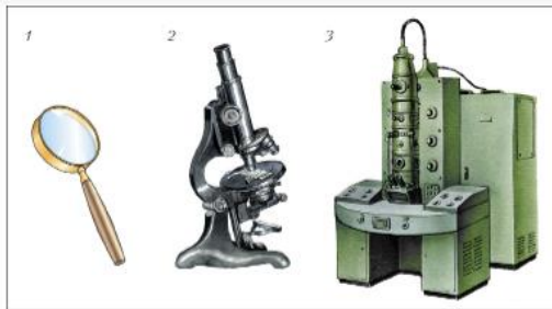
Рис. 4. Увеличительные приборы: 1 — ручная лупа; 2 — световой микроскоп; 3 — электронный микроскоп
