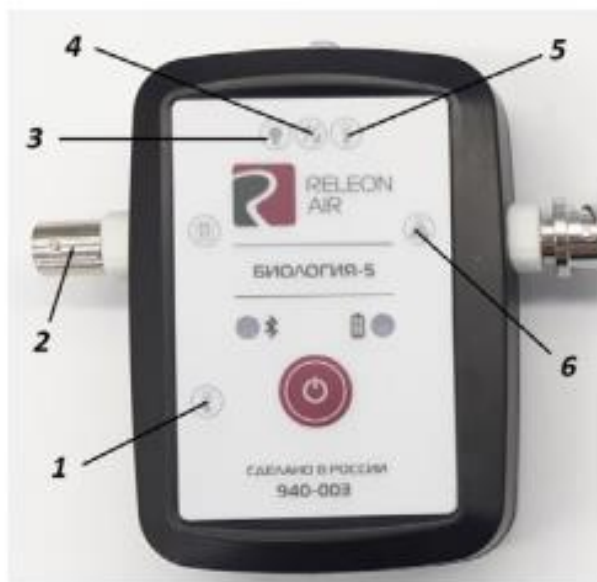
Рис. 2. Мультидатчик по биологии: 1 — температура растворов, 2 — эл мость, 3 — освещённость, 4 — относительная влажность воздуха, 5 — окружающей среды, 6 — pH
