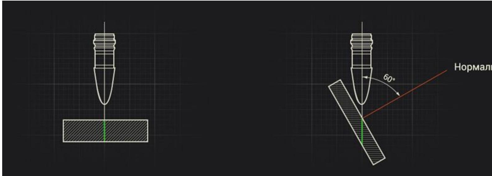
Отклонение от нормали – это угол вхождения снаряда. Он определяет толщину приведённой брони – расстояния, которое необходимо пройти снаряду, чтобы нанести урон. Чем больше угол вхождения, тем больше величина приведённой брони.
