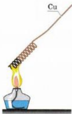
Рис. 1. Прокаливание медной проволоки
